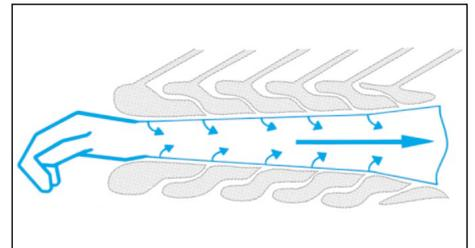
Der Querschnitt durch eine original Slide Styler Manschette zeigt die überlappenden Luftkammern. Eine technische Voraussetzung für hohen Behandlungserfolg.
